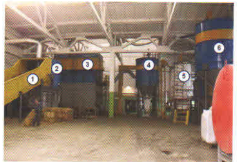
Внешний вид комплекса оборудования для производства гранулированного удобрения из помета, обеззараженного методом торрефикации: 1 – загрузочная платформа исходного помета 2 – дробилка грубого измельчения, 3 – бункер для измельченной соломы, 4 – бункер для гранул, 5 – реактор для торрефикации гранул, 6 – бункер для обеззараженных (торрефицированных) гранул из помета
